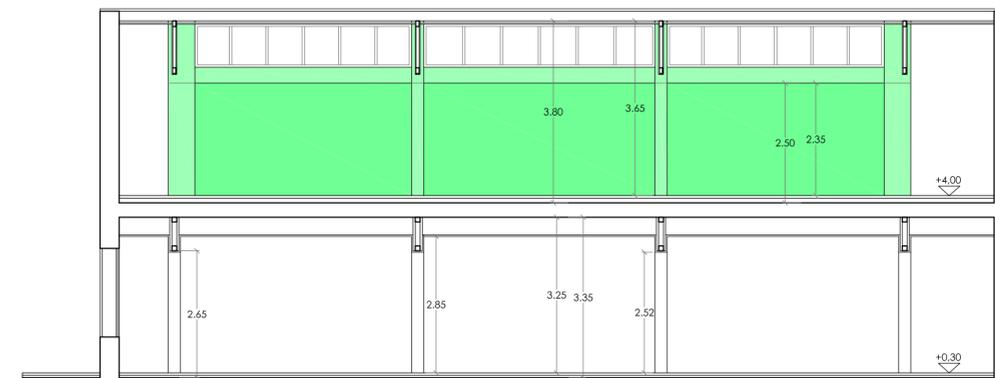
SECCIÓN TRANSVERSAL A-A'. Estado reformado
