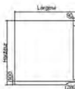
Altura : 1055 mm+ 130 mm de tejado    X Origen del bloque    Anchura : 1315 mm    Longitud : 1740 mm    Peso : 330 Kg
